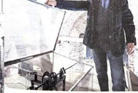
Сердце часов — сложный механизм, который заставляет двигаться стрелки на трех циферблатах, расположенных с разных сторон башни костела Святого Ксаверия
